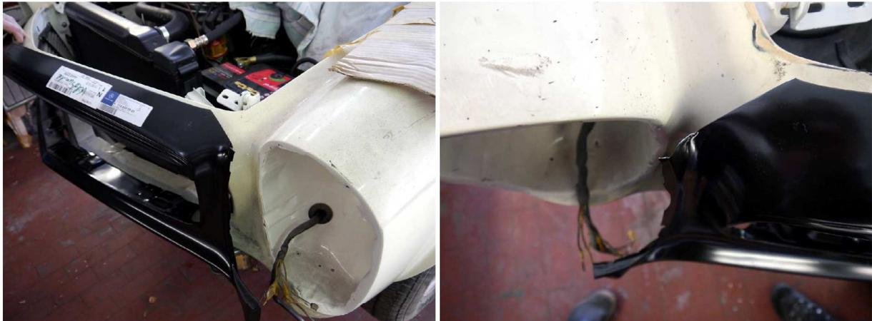
In dem für die Reparatur in Frage kommenden Betrieb befindet sich ein baugleiches Fahrzeug in der Totalrestauration. An diesen werden die Abmessungen für die in Handarbeit anzufertigenden Karosserieteile abgenommen.
