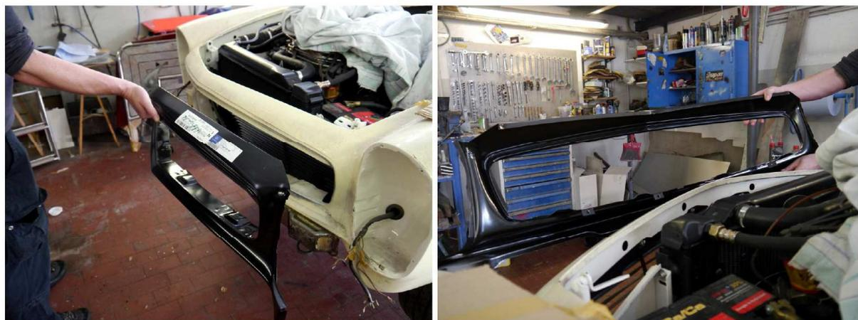
Zum Ersetzen des Frontmittelteils sind die Schweißverbindungen zu trennen und die Verbindungsstellen der im Fahrzeug verbleibenden Karosseriebleche für ein erneutes Verschweißen zu richten und vorzubereiten. Wegen eines bereits 1994 erlittenen Frontschadens wurden diverse Schweißverbindungen am Vorderwagen schon einmal aufgetrennt und mit damals üblichen Reparatur- Schweißmethoden wieder aufgebaut.
