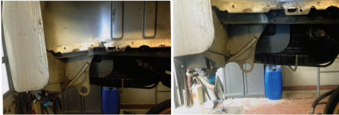
Rechter hinterer Längsträger – Ansicht von rechts (Radhaus, rechtes Hinterrad ausgebaut)
