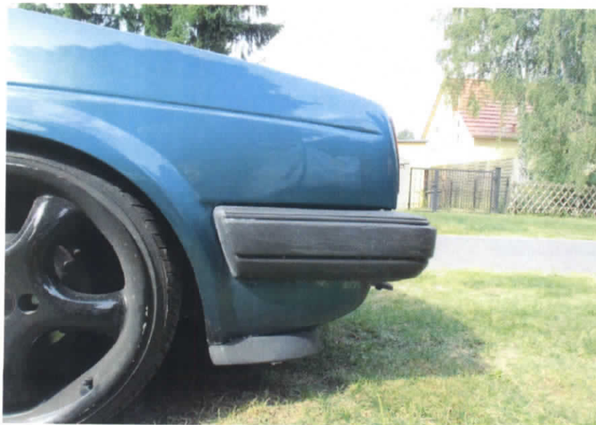
Bild 6: Kotflügel instandgesetzt Stoßfänger mit Beschädigungen unterhalb des Stoßfängers Spuren der Lackinstandsetzung
